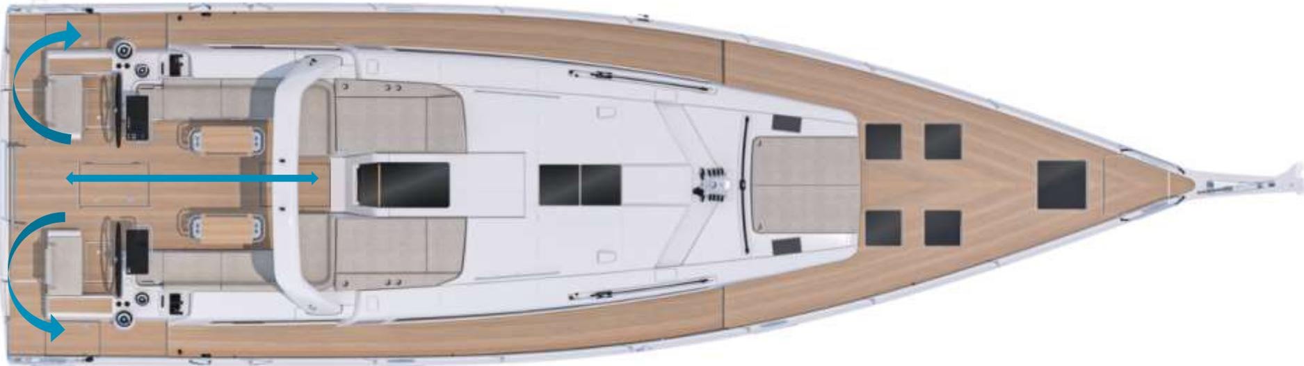
Mains courantes sur: consoles, arceau de GV, tables de cockpit, roof
