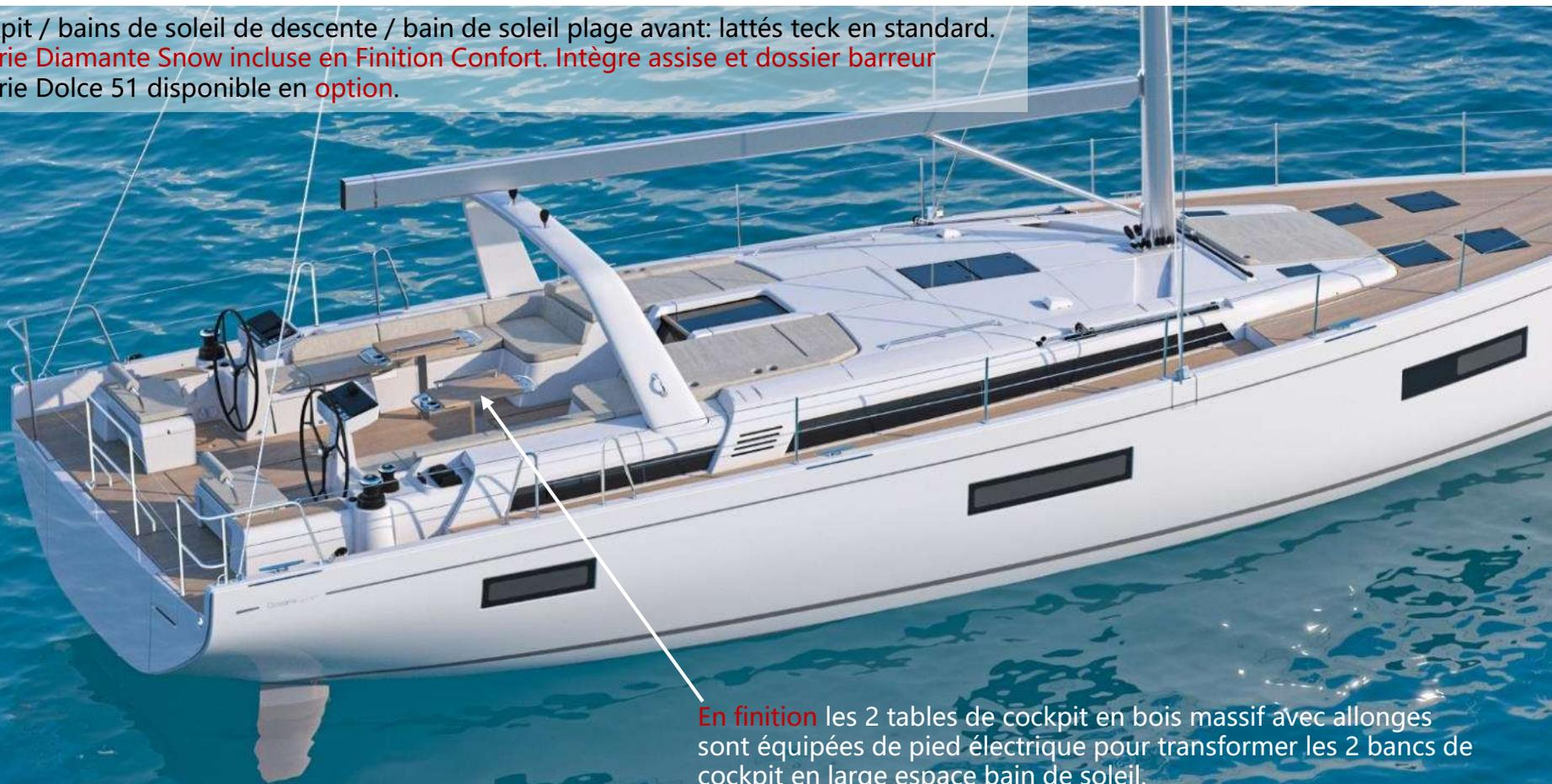
**En finition** les 2 tables de cockpit en bois massif avec allonges sont équipées de pied électrique pour transformer les 2 bancs de cockpit en large espace bain de soleil.
